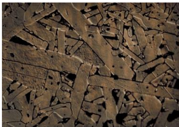
Oberfläche SSiC geätzt (1000:1)
